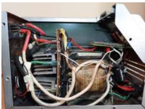
Рис 3. Инвертор мощностью 3кВт с прямоугольным выходным напряжением 220В и частотой 50 Герц
