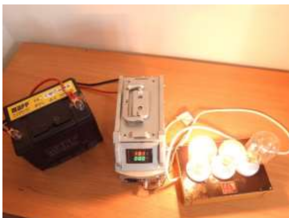
Рис 4. Инвертор мощностью 3кВт с прямоугольным выходным напряжением 220В и частотой 50 Герц
